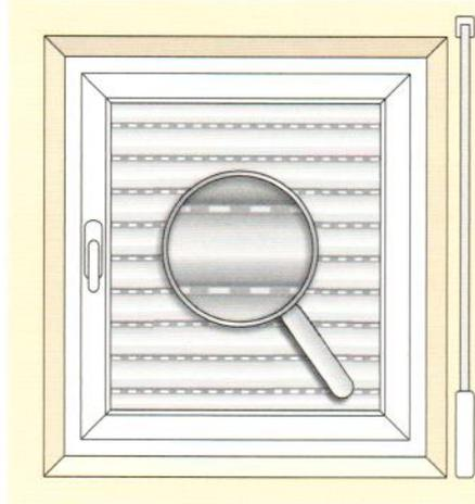
An sonnigen und heißen Tagen sollten Sie beachten, dass die Licht und Lüftungsschitze geöffnet bleiben! Sie sorgen so für eine ausreichende Hinterlüftung Ihres Rollladens und vermeiden einen Hitzestau, der dazu führen könnte, dass der Rollladen ausbaucht.
