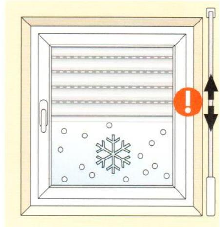
An kalten und frostigen Tagen könnte Ihr Rollladen anfrieren. Bitte wenden Sie in diesem Fall keine Gewalt an. Lassen sie spezielle motorbediente Rollladen unbeaufsichtigt laufen, und stoppen Sie sofort falls der Rollladen angefroren ist. Schalten Sie ggf. automatische Steuerungen und Zeitschaltuhren im Winter zusätzlich auf Handbedienung.
