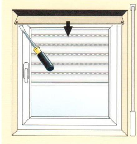
Achten Sie darauf, dass die Revisionsöffnung immer frei zugänglich bleibt. Der Kastendeckel sollte nicht überputzt oder tapeziert werden. Lassen Sie Reparaturen stets durch Ihren Fachbetrieb ausführen!
