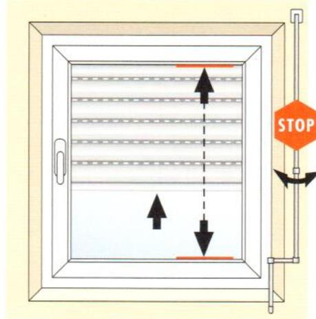
Achten Sie auf die korrekte Drehrichtung der Kurbel! Kurbeln Sie nicht weiter, wenn Ihr Rollladen ganz geöffnet bzw. geschlossen ist. Bei Kurbelantrieb Kurbeln am Gelenk nicht zu stark ablenken, max. 30.°
